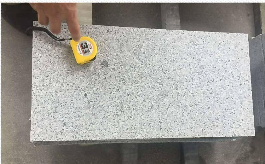
写真は「新603」のJB板の写真です。黒タマが少し出ますので、本磨よりはJBの方が向いています。
